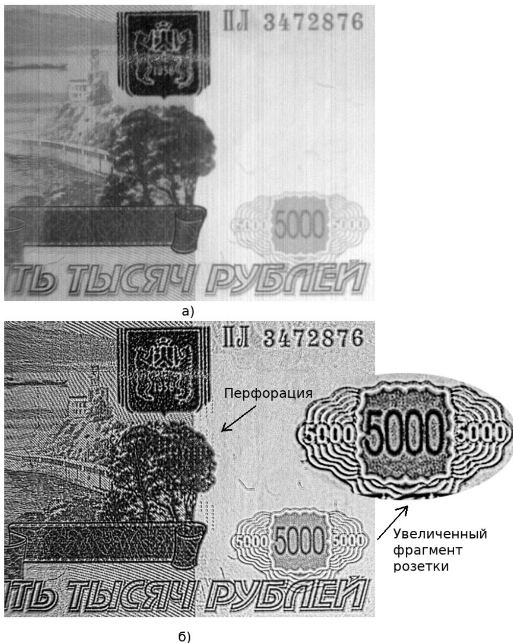
Рис. 3. Фрагмент пятитысячной купюры - а) изображение CMOS камеры, и б) изображение макета RTNS/CMOS камеры с увеличенным фрагментом розетки «5000».
