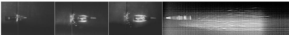
Рис. 6 и 7. Одновременная регистрация пробоя 30 мм снарядом алюминиевого листа методами – покадровой съемки (трехкамерный регистратор НАНОГЕЙТ-9/3) и хронографии (регистратор ВидеоСтринг).
