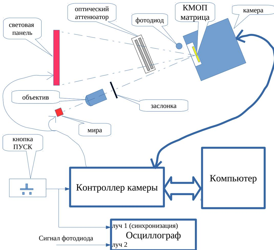
Рис. 2 Функциональная схема оптического стенда.
